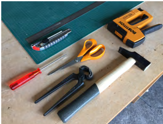
Werkzeuge für die Arbeit der Schüler. Für das Entfernen der Klammern auf dem Rahmen haben sich Schraubenzieher und Beisszange bewährt.
