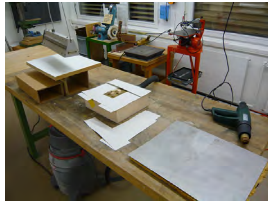
Heizfläche und Tiefziehtisch sollen direkt nebeneinander liegen. Die Kabelführung beachten, damit kein Netzkabel schmelzen kann.
