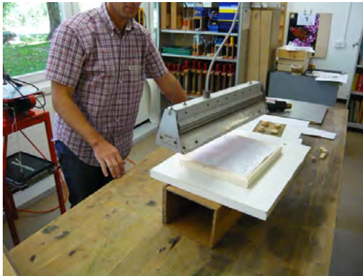
Den Arbeitstisch vor der grossen Hitze schützen. Nach dem Heizvorgang den Strahler sofort ausschalten.
